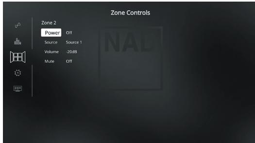
En fonction des paramètres modifiés dans la rubrique « Zone Setup » (Configuration des zones) de la section « Setup Menu » (Menu de configuration), il est possible de configurer et de gérer la Zone 2 grâce à cette fenêtre « Zone Controls » (Commandes de zones).
