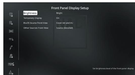
L'écran du panneau avant et le Système de menus incrustés (OSD) peuvent afficher les informations de différentes façons grâce aux paramètres du menu « Front Panel Display Setup » (Configuration de l'écran du panneau avant).
