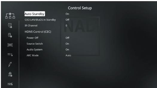
Le T 778 prend en charge les fonctions Commandes HDMI (CEC) et Retour de canal audio (ARC). Les deux fonctions sont possibles si des appareils externes prenant en charge ces fonctions sont raccordés au T 778 par connexion HDMI.
