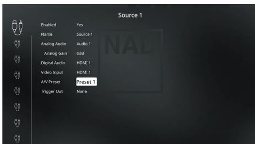
Dans l'exemple ci-dessus, les paramètres de « Preset 1 » (Préréglage 1) sont affectés à « Source 1 ». Lorsque « Source 1 » est accédée, les paramètres de « Preset 1 » (Préréglage 1) sont appliqués à « Source 1 ». Vous pouvez tout de même contourner manuellement les paramètres du préréglage A/V affecté en utilisant d'autres paramètres/un autre préréglage en appuyant sur les touches appropriées de la télécommande.
