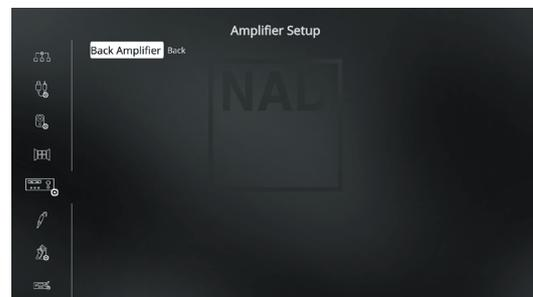
Si les haut-parleurs ambiophoniques arrière ne sont pas utilisés dans la zone principale, leurs voies d'amplificateur ambiophonique arrière peuvent être affectées à « Back » (Arrière), « Front (Bi-Amp) » (Avant (Bi-ampli)), « Zone 2 » et « Height 2 » (Hauteur 2).
