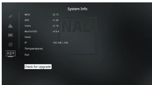
« System Info » (Info système) présente l'information au sujet des versions courantes des micrologiciels MCU, DSP, Vidéo et BluOS/OSD, ainsi que le numéro de série, l'adresse IP, la température et la vitesse du ventilateur de l'appareil. L'information système affichée ci-dessus est à titre de référence seulement.
