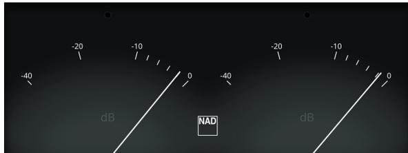
\* Le VU-mètre surveille ou reflète le niveau audio de la source BluOS courante. Si « Mute » (Sourdine) est activé, il ne sera pas possible de fermer le VU-mètre ou d'aller à un niveau minimum, car c'est la sortie audio qui est mise en sourdine.
