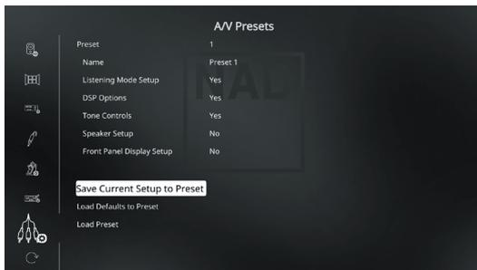
Depuis la ligne du menu « Save Current Setup to Preset » (Sauvegarder la configuration courante dans le préréglage), utilisez la touche [D] pour sauvegarder les paramètres ci-dessus dans « Preset 1 » (Préréglage 1). L'OSD ci-dessous s'affiche, confirmant que les paramètres ci-dessus ont été sauvegardés dans « Preset 1 » (Préréglage 1).
