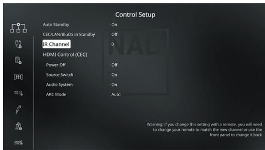
Le T 778 est en mesure de fonctionner sur un canal IR auxiliaire. Cela est particulièrement utile si vous utilisez deux produits NAD qui peuvent être contrôlés par des commandes de télécommande similaires. Grâce au canal IR auxiliaire, deux produits NAD différents peuvent être commandés indépendamment dans la même zone en les réglant sur des canaux IR différents.
