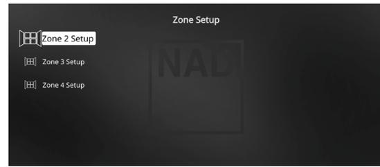
La fonction Zone vous permet d'écouter simultanément d'écouter des sources sonores différentes parmi toutes les sources activées dans les différentes zones.
