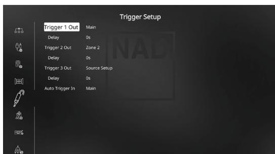
Le M17 comporte trois Sorties Asservissement +12 V CC (+1 2V DC Trigger Output) que vous pouvez utiliser pour activer un appareil ou une chaîne qu'il alimente. Une entrée d'asservissement peut également être configurée pour activer ou désactiver une section du M17.
