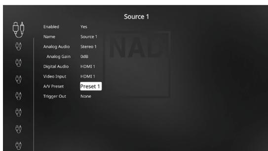
Dans l'exemple ci-dessus, les paramètres de « Preset 1 » (Préréglage 1) sont sélectionnés pour la source 1. Lorsque la source 1 est accédée, les paramètres de « Preset 1 » (Préréglage 1) sont appliqués à la source 1. Vous pouvez tout de même sélectionner manuellement un autre préréglage A/V pour une source spécifiée en appuyant sur les touches de la télécommande appropriées.
