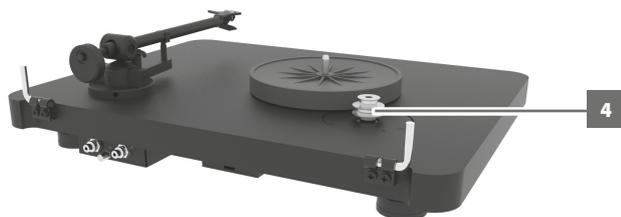
4 Ajuste de nuevo el tornillo y coloque la correa de transmisión y el plato.
