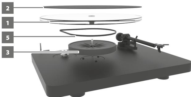
2 Instale el plato (1) sobre la base del plato (3) y coloque el disco de fieltro (2) sobre el plato.
