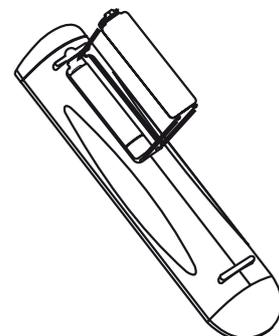
Batteriefachdeckel durch ausrichten und einführen in die aussparungen wieder einsetzen. Batteriefachdeckel hineindrücken bis er mit einem hörbaren klick schliesst.
