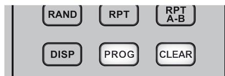
Verwenden Sie die Taste [PROG], um den Programmiermodus zu starten, zu prüfen, zu bearbeiten oder zu verlassen. Durch gleichzeitiges Drücken der Tasten [PROG] und [CLEAR] kann ein programmierter Track während der Programmprüfung oder -bearbeitung gelöscht werden. [Siehe auch „PROGRAMMWIEDERGABE“ im Abschnitt „VERWENDUNG DES C 546BEE – CD-MODUS“ auf der Seite „BETRIEB“.](#)
