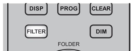
Le bouton [FILTER] est utilisé pour sélectionner la bande passante du filtre passe-haut pour le CD, MP3 et WMA en cours de lecture. Les options sont NORMAL (normale) ou SLOW (lente). Pour certains enregistrements, la bande passante SLOW (lente) peut offrir une large plage de fréquences et une impression spatiale.
