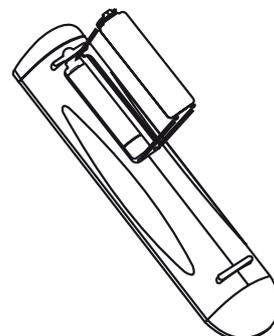
Remettez en place le couvercle du compartiment des piles en alignant les deux languettes avec les trous, puis en les y insérant. Appuyez sur le couvercle du compartiment des piles pour le mettre en place (vous ressentirez un déclic).
