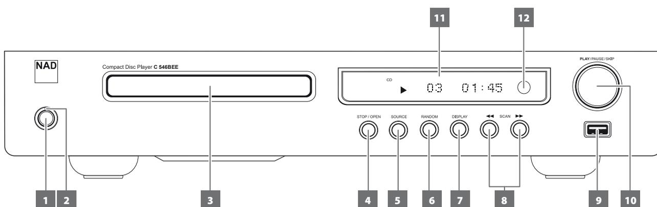
**1 BOUTON STANDBY (VEILLE) :** appuyez sur ce bouton pour allumer le C 546BEE. Le voyant à LED Standby (Veille) passe de la couleur jaune à la couleur bleue, et l'affichage fluoescence à vide (VFD) s'allume. Une nouvelle pression sur ce bouton fait repasser l'appareil en mode Standby (Veille).
