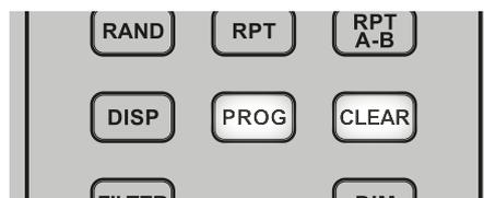
使用“【PROG】（编程）”按键来开始、检查、编辑或退出编程模式。与编程按键联合使用，“【CLEAR】（清除）”按键允许在检查程序或编辑序列时删除已编程的曲目。请参考“操作”中的“使用C 546BEE——CD模式”部分有关“编程”项的内容。
