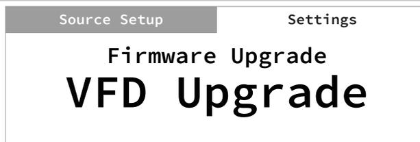
Wählen Sie „Firmware Upgrade“ (Firmware-Aktualisierung), um die VFD- oder BT-Aktualisierung zu veranlassen. Wählen Sie in jedem Aktualisierungsmodus „Yes“ (Ja), um den Aktualisierungsprozess zu starten, oder „No“ (Nein), um die aktuelle Firmware beizubehalten.
