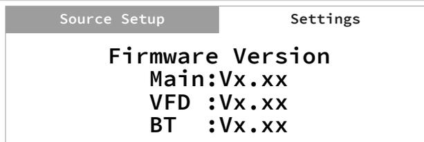
Es werden Details zur Firmware-Version von „Main“ (MCU), „VFD“ (Display) und „BT“ (Bluetooth) angezeigt. Wenn das MDC BluOS-Modul installiert wurde, werden keine Details zur BT-Firmware-Version angezeigt.
