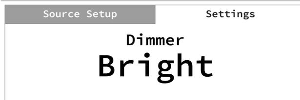
Mit der DIMMER (Verdunkelungs-)Funktion kann der Helligkeitsgrad des Frontplatten-Displays eingestellt werden.
