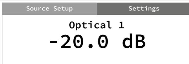
Drücken Sie einmal oder mehrmals auf [↵], bis „Source Setup“ hervorgehoben wird. Drücken Sie < oder >, um andere Optionen des Hauptmenüs auszuwählen: „Settings“ (Einstellungen) und „BluOS Setup“ (nur bei Installation des MDC BluOS-Moduls verfügbar).
