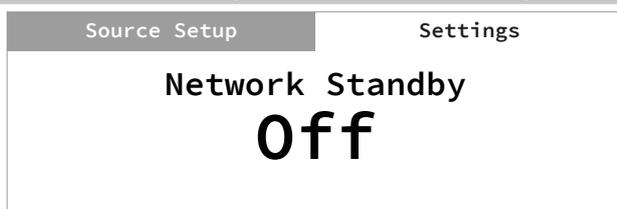
Im Modus „Network Standby“ (Netzwerkbereitschaft) verbleibt die Netzwerkverbindung bei einem reduzierten Systemleistungsgrad im Bereitschaftsmodus.
