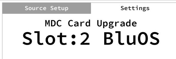
Mit MDC CARD UPGRADE (MDC-KARTEN-UPGRADE) werden die MDC-Module festgestellt und angezeigt, die in den MDC-Steckplätzen in der Rückplatte installiert sind.
