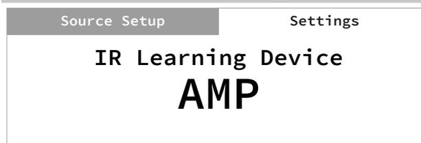
Mit „IR Learning Device“ (IR-Lerngerät) kann eine nicht von NAD hergestellte Fernbedienung einfache AMP- und BluOS-Fernbedienungscodes lernen. Nach dem Lernen dieser Codes kann die konfigurierte, nicht von NAD hergestellte Fernbedienung zum Ausgeben von Anweisungen und zum Bedienen des C 368 verwendet werden.
