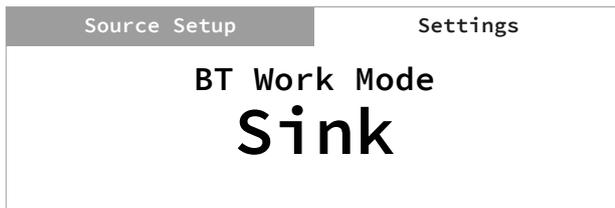
„Bluetooth (BT) Work Mode“ (Bluetooth-Arbeitsmodus) definiert die zwei Rollen des C 368 als „Bluetooth Sink“ (Bluetooth-Senke) oder „Bluetooth Source“ (Bluetooth-Quelle).
