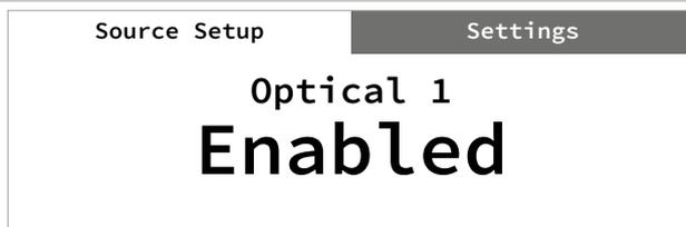
Eine Signalquelle kann mit dieser Option aktiviert oder deaktiviert werden. Das ist besonders nützlich, wenn nur wenige Signalquellen vorhanden sind. Bei der Auswahl direkt von der Frontplatte werden deaktivierte Signalquellen übersprungen.
