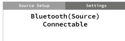
**Connectable/Discoverable (Verbindungsfähig/Auffindbar):** Der C 368 ist für das Verbinden bzw. Koppeln mit anderen Quellgeräten in der gleichen Bluetooth-Netzwerkumgebung bereit. Standardmäßig werden keine verbindungs-fähigen oder auffindbaren Bluetooth-Geräte angezeigt, da das Gerät noch nicht in den Modus „Inquiring“ (Interessiert) umgeschaltet hat.
