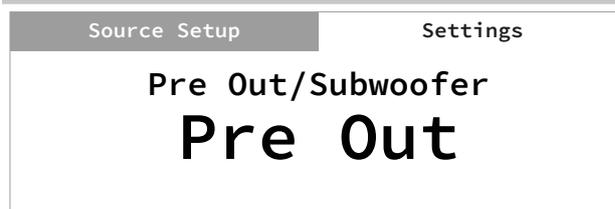
Mit der Funktion „Pre Out/Subwoofer“ können Sie die Funktion der PRE-OUT- oder SUBWOOFER-Anschlüsse auswählen.
