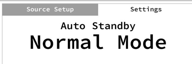
Das automatische Standby ist ein integrales Feature des C 368, das den europäischen Ökodesignvorschriften entspricht. Der C 368 kann so eingerichtet werden, dass er automatisch in den Standby-Modus übergeht, wenn es innerhalb von 20 Minuten keine Benutzeroberflächeninteraktion und keine aktive Quelle gibt.
