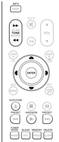
**10 SPK A, SPK B:** Die Tasten [SPK A] und [SPK B] schalten die Lautsprecher ein und aus, die an den Ausgängen Speakers A und Speakers B des entsprechenden Receivers oder integrierten Verstärkers angeschlossen sind. Durch Drücken von [SPK A] werden die an den Ausgängen Speakers A angeschlossenen Lautsprecher ein- und ausgeschaltet. Durch Drücken von [SPK B] werden die an den Ausgängen Speakers B angeschlossenen Lautsprecher ein- und ausgeschaltet.
