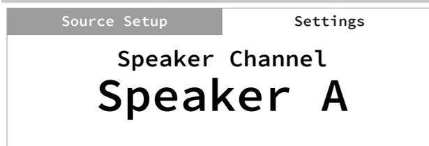
SPEAKER CHANNEL (Lautsprecherkanal) ermöglicht das Aktivieren und Deaktivieren der mit den Anschlüssen SPEAKERS A und SPEAKERS B auf der Rückplatte verbundenen Lautsprecher.
