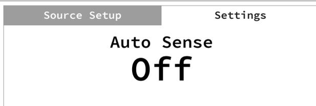
Die Funktion „Auto Sense“ (Autom. Wahrnehmung) ermöglicht es dem C 368, aus dem Bereitschaftsmodus aufzuwachen, wenn eine mit dem Netzwerk verbundene App oder ein aktiver Quelleneingang als entsprechender Auslöser fungieren.
