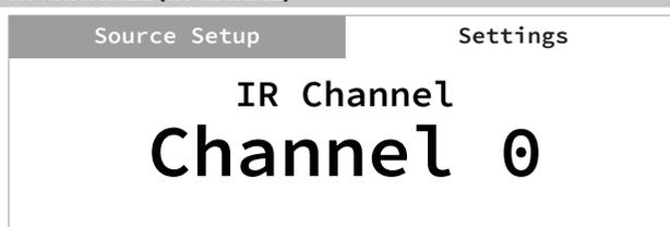
Der C 368 kann über einen alternativen IR-Kanal betrieben werden. Dies ist nützlich, wenn Sie zwei NAD-Produkte haben, die durch ähnliche Fernbedienungsbefehle bedient werden können. Mit dem alternativen IR-Kanal können zwei verschiedene NAD-Produkte unabhängig voneinander in derselben Zone gesteuert werden, indem jedes Produkt auf einen anderen IR-Kanal eingestellt wird.
