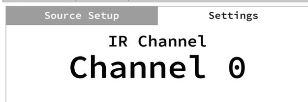
Le C 368 peut fonctionner sur un canal IR substitut. C'est particulièrement utile si vous avez deux produits NAD qui peuvent être opérés par des commandes de télécommande similaires. Grâce au canal IR substitut, deux produits NAD différents peuvent être commandés indépendamment dans la même zone en les réglant sur des canaux IR différents.
