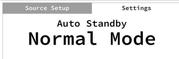
La fonction de mise en veille automatique est une caractéristique intégrale du C 368 conforme aux règlements écodesign européens. Le C 368 peut être réglé pour passer automatiquement au mode de veille s'il n'y a pas d'interaction de l'interface d'utilisateur et qu'aucune source n'est active pendant 20 minutes.
