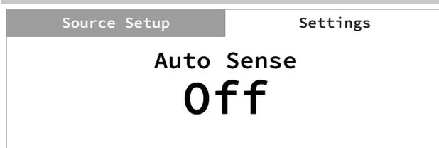
La fonction Auto Sense permet le réveil automatique du C 368 dès qu'il est déclenché par une appli du réseau ou une source branchée active.
