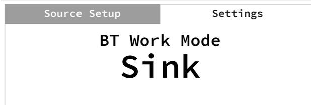
La fonction BT (Bluetooth) Work Mode définit les deux rôles de C 368 soit un récepteur (sink) ou une source Bluetooth.
