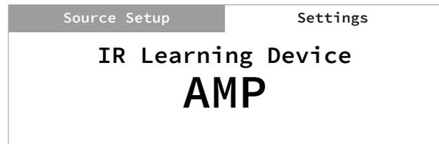
La fonction IR Learning Device permet à toute télécommande de marque autre que NAD d'apprendre les codes de commande de base AMP et BLS (BluOS). Grâce aux codes appris, la télécommande autre que NAD peut alors être utilisée pour commander le C 368.
