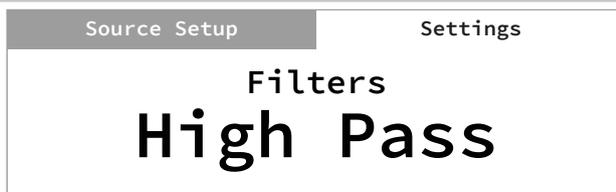
Les filtres offrent la biamplification ou l'intégration du caisson de graves simples en ajoutant les filtres requis pour rediriger les basses fréquences au caisson de graves.
