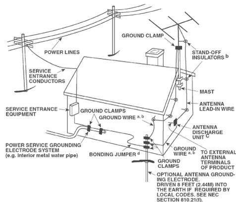
15. **Foudre** - Afin d'assurer une meilleure protection de cet appareil pendant les orages, ou lorsqu'il reste inutilisé et sans surveillance pendant de longues périodes, débranchez la prise murale et déconnectez l'antenne ou le système de câbles. Cela évitera toute détérioration de l'appareil par la foudre ou par les surtensions de secteur.
