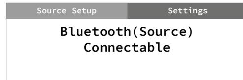
**Connectable/Discoverable :** Le C 368 est ouvert à la connexion ou au jumelage avec d'autres appareils sources dans le même réseau Bluetooth. Par défaut, aucun appareil Bluetooth connectable ou découvrable n'est affiché, car l'appareil ne s'est pas encore mis en mode de recherche (Inquiring).
