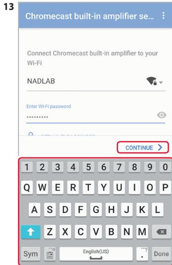
使用屏幕键盘在提供的字段中输入您的Wifi密码。选择“CONTINUE”（继续）继续下一步。注意，也可以选择“GET WI-FI PASSWORD”（获取Wi-Fi密码），复制来自当前移动设备的Wi-Fi密码。
