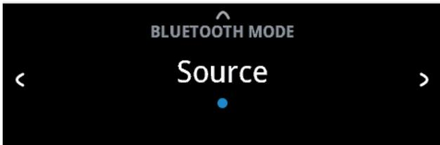
Réglez le paramètre « Bluetooth Mode » (Mode Bluetooth) sur « Source ». Assurez-vous que l'antenne Bluetooth est branchée à la borne BT du panneau arrière.
