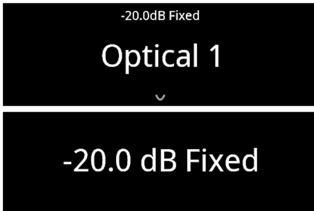
Au paramètre de réglage du volume « Fixed » (Fixe), l'écran du panneau avant affiche « xx.x dB Fixed » (xx,x dB fixe) pendant le réglage de la commande de volume.
