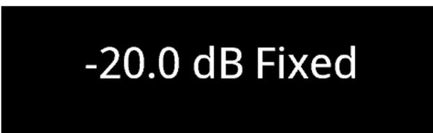
Au réglage du niveau de volume « Fixed » (Fixe), l'écran du panneau avant affiche « xx.x dB Fixed » (xx.x dB fixe) pendant le réglage de la commande de volume.
