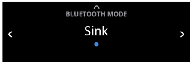
Configurez le réglage « Bluetooth Mode » (Mode Bluetooth) sur « Sink » (Récepteur). Amorcez le jumelage de votre appareil Bluetooth avec le C 389 en suivant la procédure ci-dessous.
